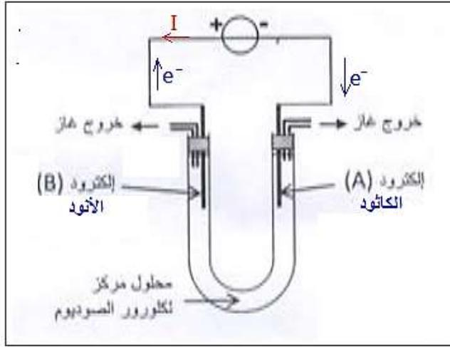
1- حسب تبيانة التركيب التجريبي منحي مرور الالكترونات عكس منحي التيار الكهربائي حيث تنتقل الإلكترونات من الإلكترود B نحو الإلكترود A (أنظر الشكل جانبه) الإلكترود A يمثل الكاثود يحدث على مستواه اختزال (أي اكتساب e<sup>-</sup>). الإلكترود B يمثل الأنود تحدث على مستواه أكسدة (أي فقدان e<sup>-</sup>).
